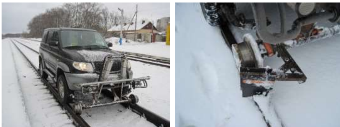
Рисунок 3 – Работа устройства для очистки рельсовых путей на машине ЛДМ-1
