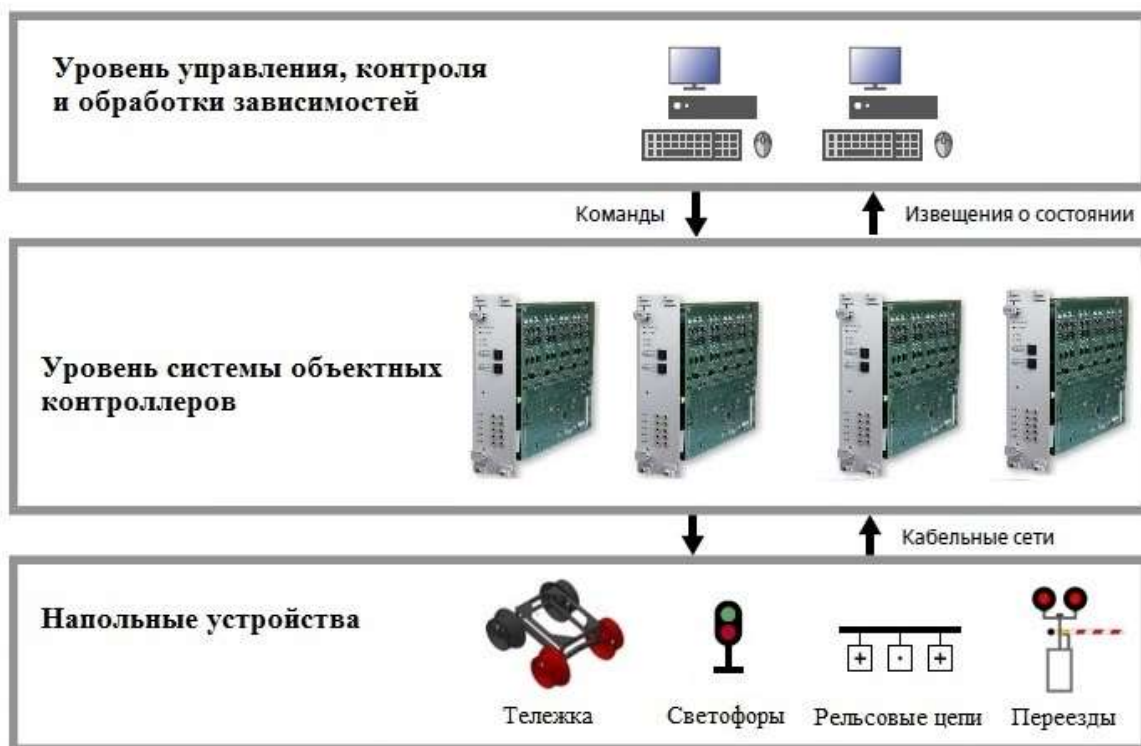
Рис. 1 Схема подсистем учебного стенда микропроцессорной АБТЦ
