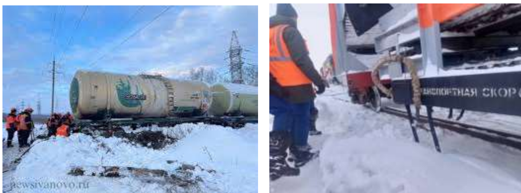
Рисунок 1 – Сход с рельс железнодорожных вагонов из-за наледи
