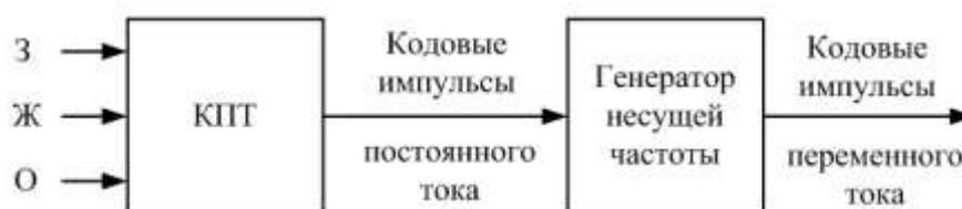
Рис. 3 Логическая схема цифровой части выходного тракта
