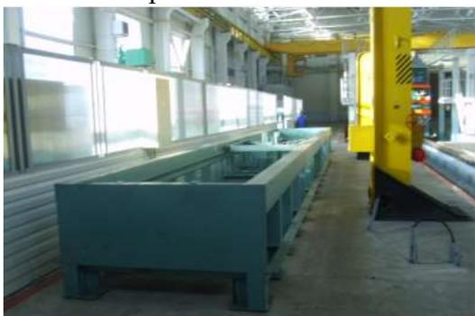
Рисунок 1. механизированное рабочее место для разборки и сборки тележек
