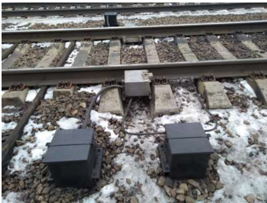
Рис. 1 - Камеры напольные малогабаритные КНМ-05 с приемником ИК излучения для подсистем КТСМ-02БТ
