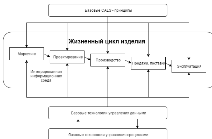
Рисунок 1 – Схема применения CALS-технологий на предприятии
