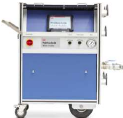
Рис.1 Комплекс для испытания тормозного оборудования вагона PDR6.
