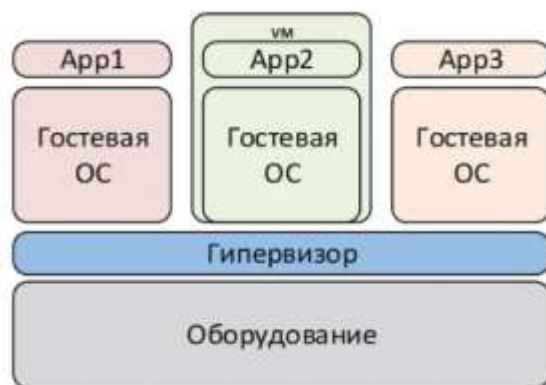
Рис. 1 - Схема работы виртуальных машин
