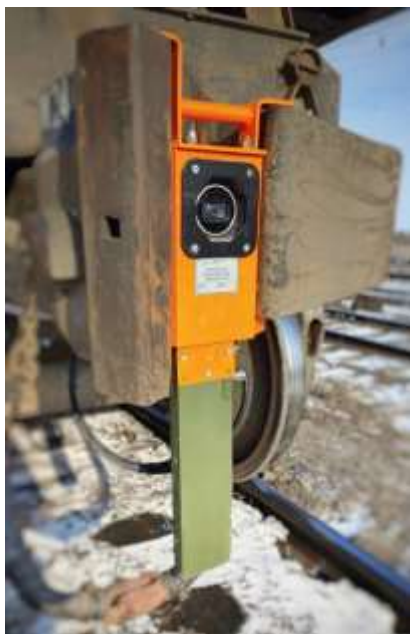
Рисунок 1 – Усовершенствованный мобильный блок на автосцепке хвостового вагона
