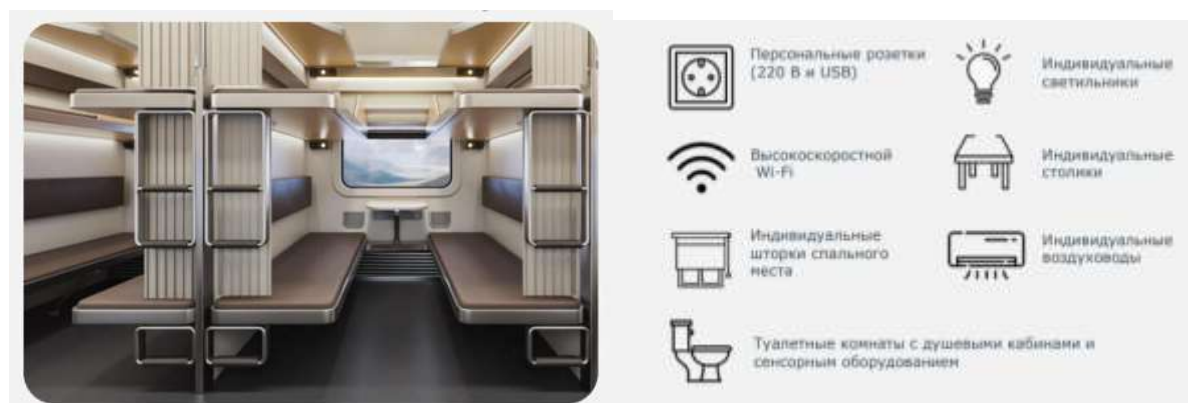
Рисунок 2 – Внутреннее наполнение некупейного вагона модели 61-4534, габарита Т
