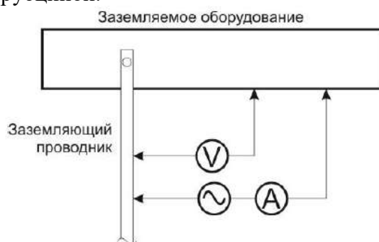
Рисунок 1 – Схема измерения сопротивления контактного соединений
