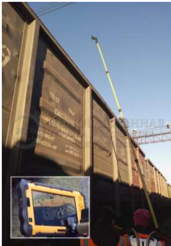
Рисунок 2 - Осмотр вагонов с использованием комплекса технического средства «Спрут» модели 5327Т
