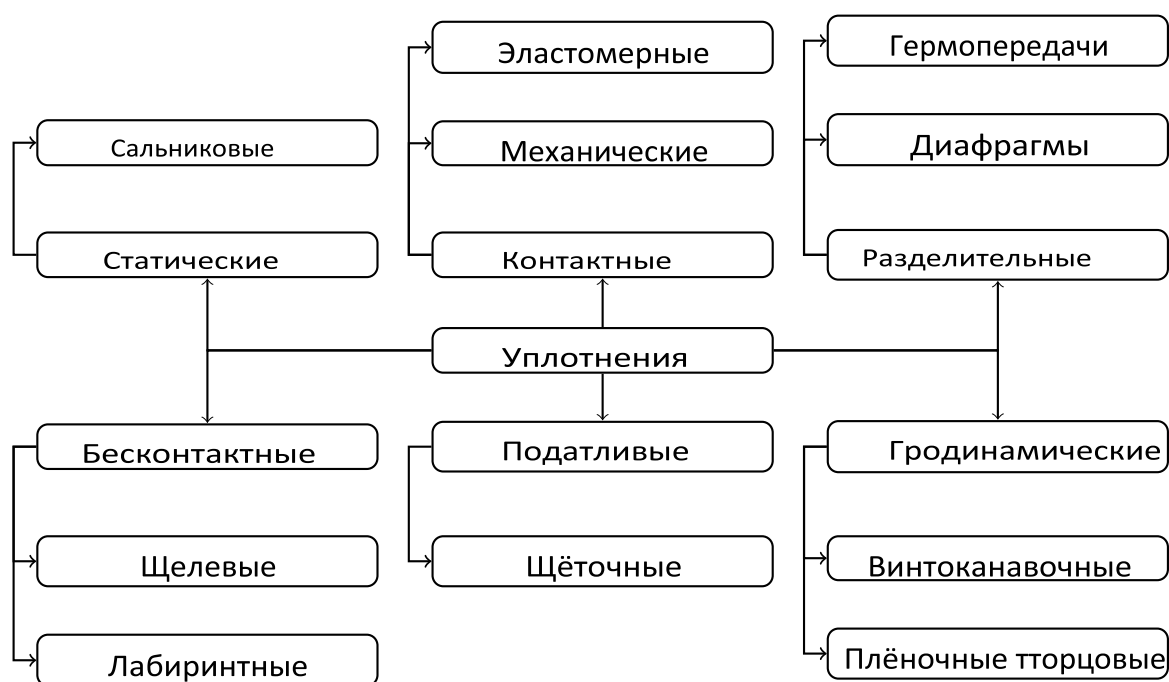
Рисунок 1. - Укрупнённая классификация уплотнений
