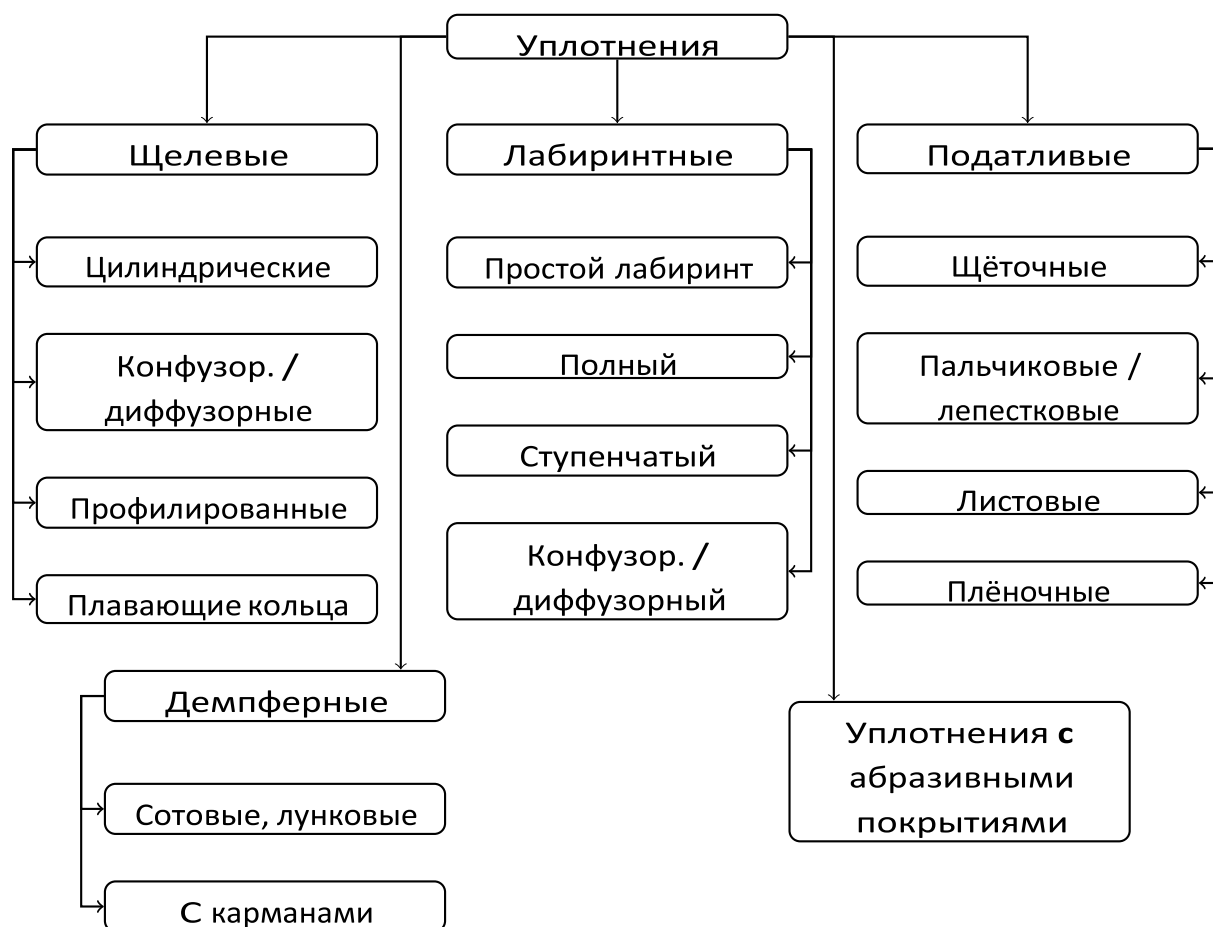
Рисунок 2.- Классификация бесконтактных и податливых уплотнений
