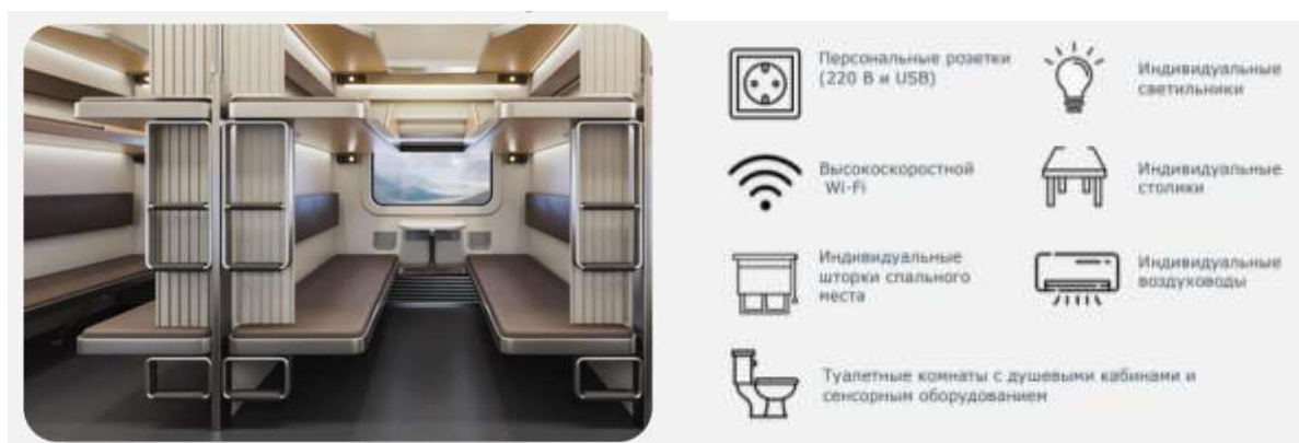
Рисунок 2 – Внутреннее наполнение некупейного вагона модели 61-4534, габарита Т
