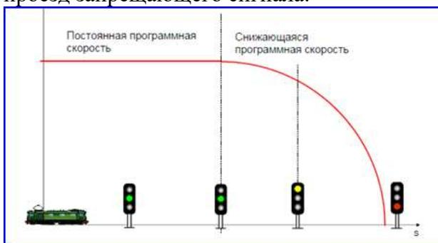
Рисунок 1.2 – Формирование программной скорости системой САУТ
