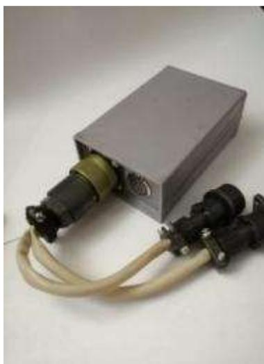
Рис.1 - Индикатор контроля входных сигналов
