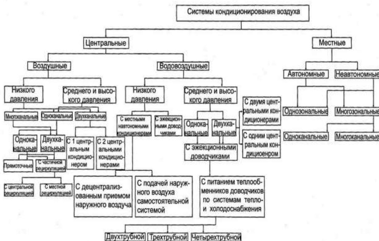
Рисунок 1– Классификация систем кондиционирования воздуха
