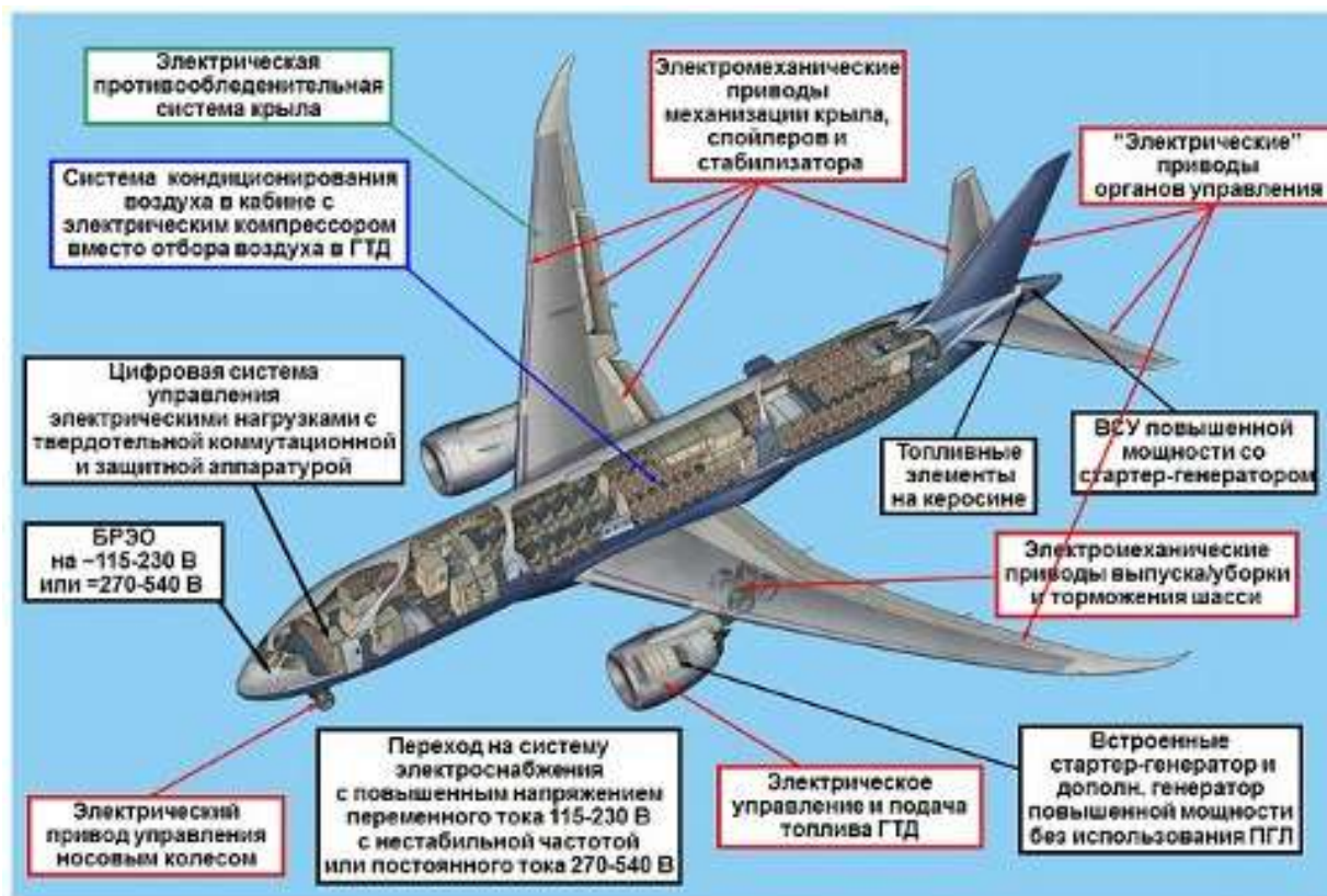
Рисунок 1 - Концепция полностью электрифицированного самолета
