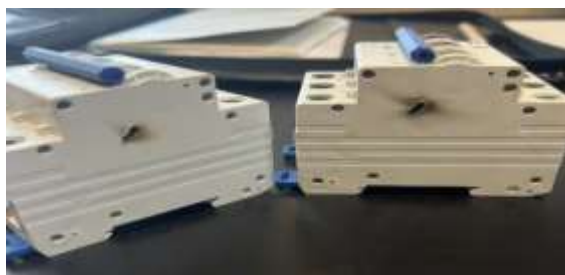
Рисунок — 3 Вводные автоматы щита управления вентиляторами вышедшие из строя вследствие перегрева контактов.
