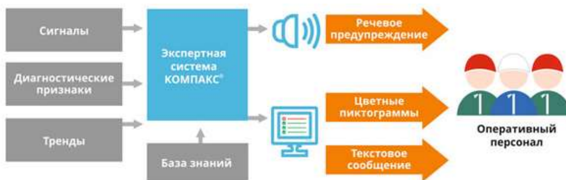
Рис. 1 Принцип работы и элементы экспертной системы КОМПАКС
