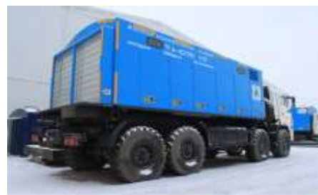
Рисунок 3 – Генератор азота на автомобильном шасси
