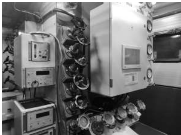
Рисунок 2 – Органы управления блока разделения воздуха станции ТКДС-100В
