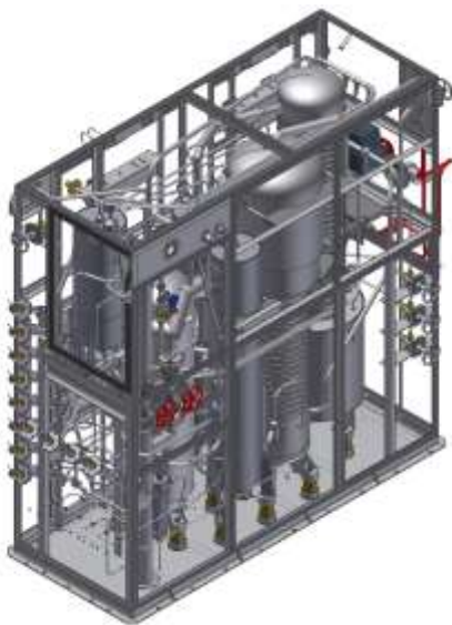
Рисунок 1 – Транспортная кислородоазотоудобывающая станция ТКДС-100В
