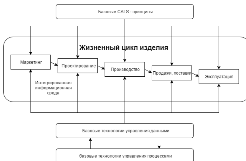
Рисунок 1 – Схема применения CALS-технологий на предприятии
