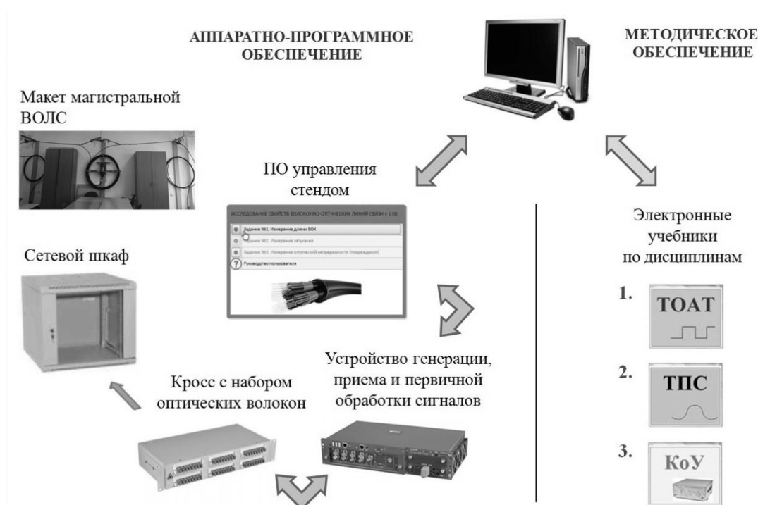
Рис. 1 Схема обучающей системы «Учебный стенд физико-технических свойств ВОЛС»
