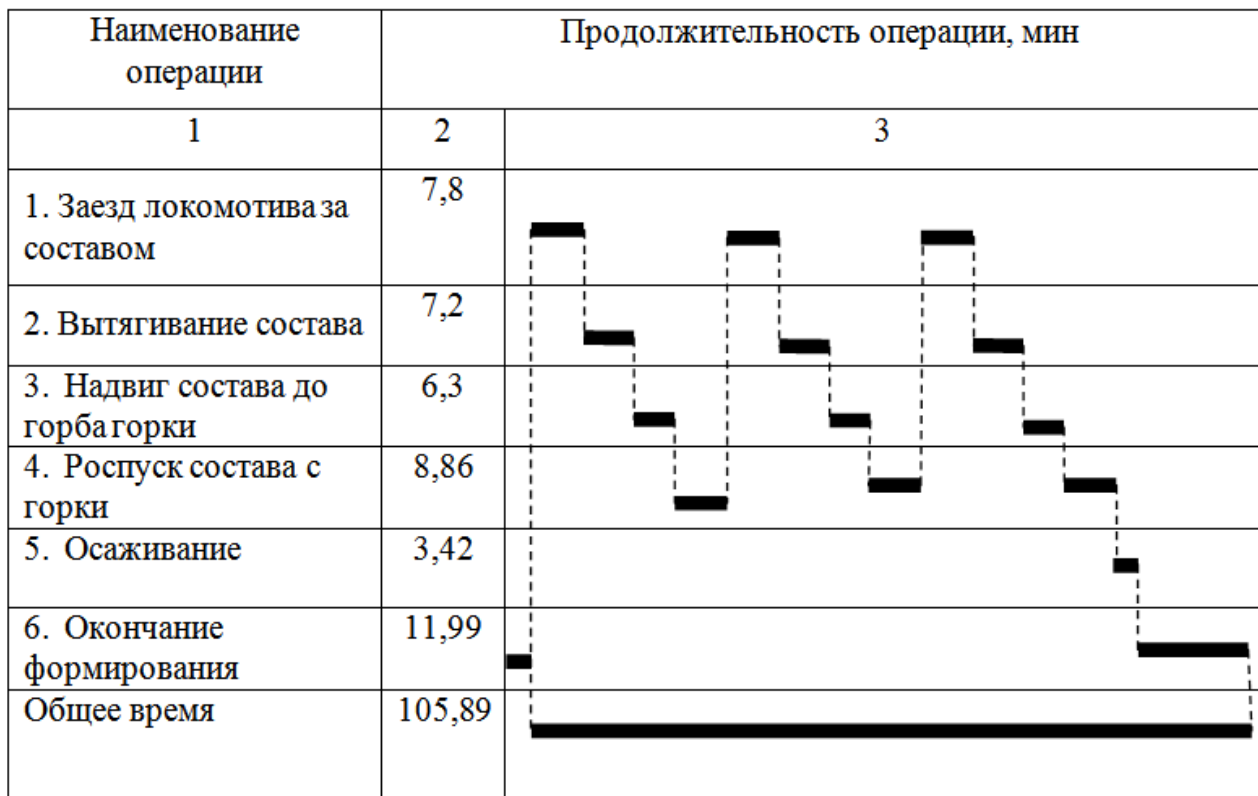
Рисунок 2 – График работы сортировочной горки до укладки съезда
