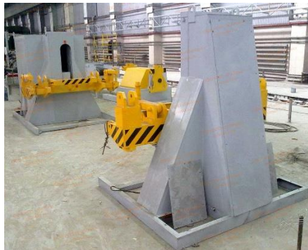
Рисунок 2. Кантователь тележек локомотива
