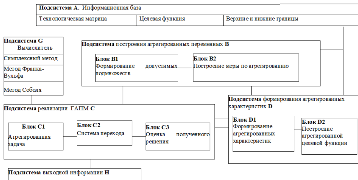
Рисунок 2 – Структурная схема алгоритмического комплекса ГАПМ
