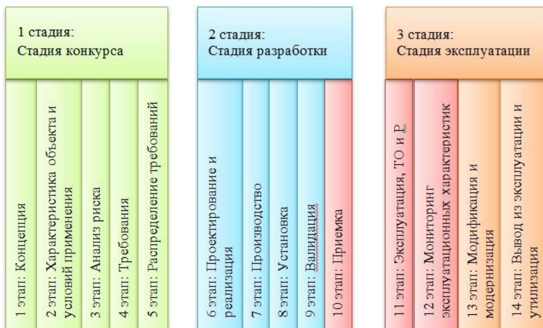
Рисунок 3 – Основные этапы жизненного цикла опоры контактной сети
