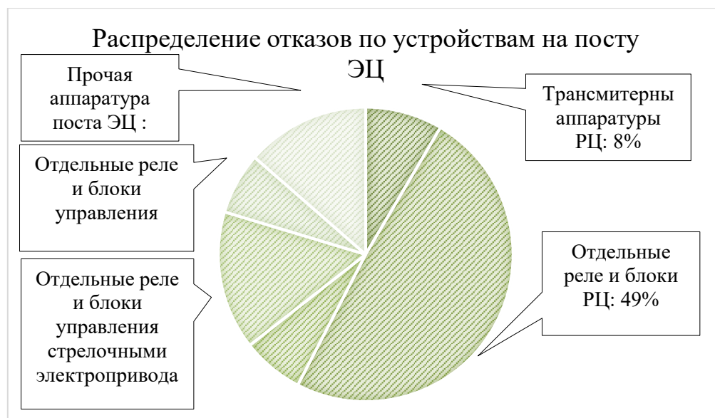
Рисунок 5 – Распределение отказов по устройствам на посту ЭЦ
