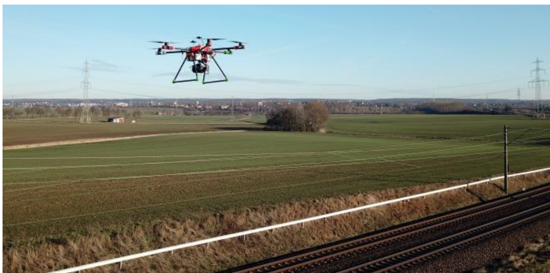
Рисунок 2 – Беспилотный летательный аппарат при исследовании воздушных линий электропередачи
