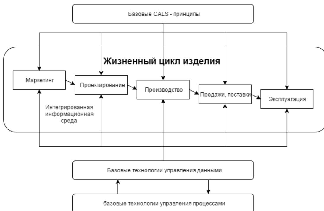
Рисунок 1 – Схема применения CALS-технологий на предприятии
