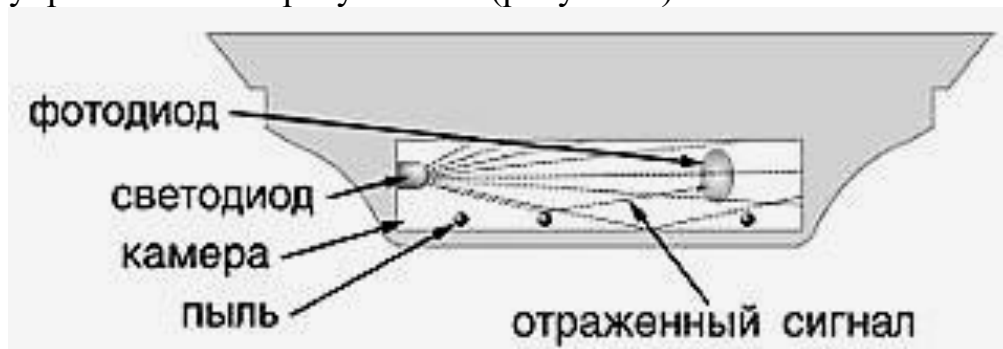
Рисунок 1. Конструкция дымовой камеры пожарного извещателя
