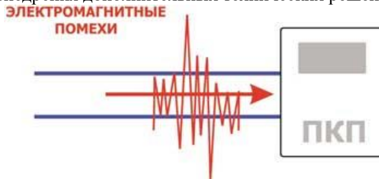
Рисунок 3. Воздействие электромагнитных помех на входной и выходной каскады проводных извещателей
