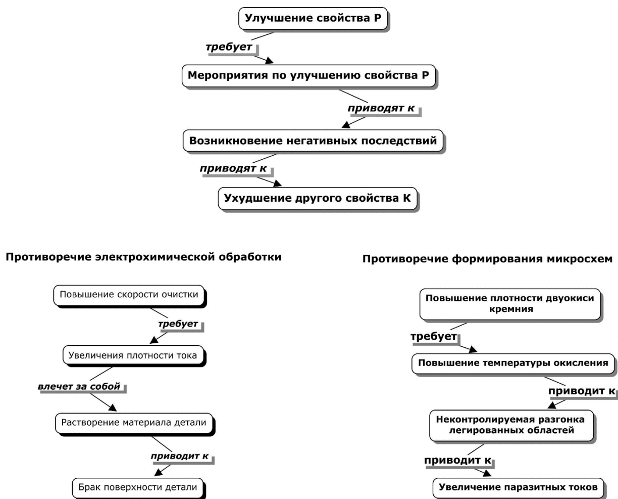
Рисунок 2. Причинно-следственные цепочки (пример)
