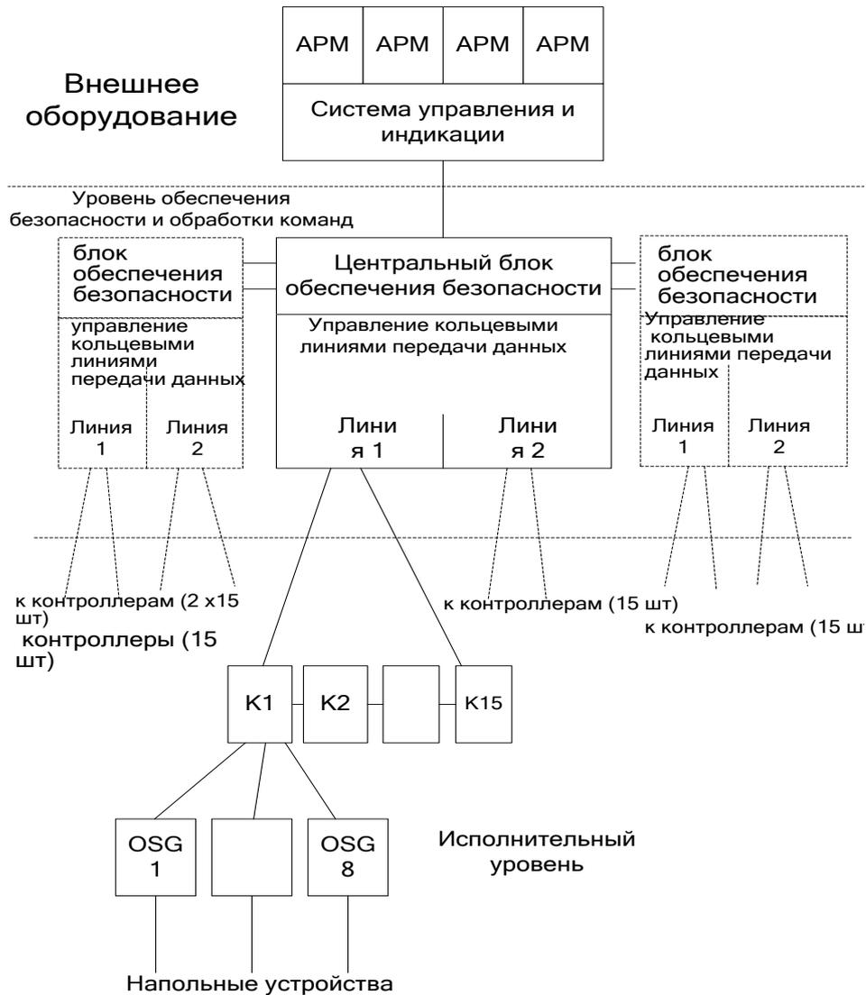
Рисунок 1 - Структурная схема системы МПЦ «EBILock-950»
