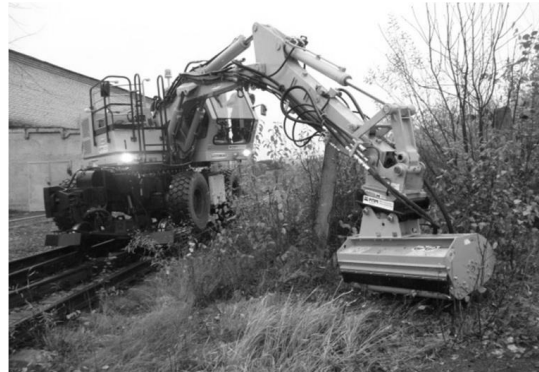
Рисунок 2 – Механизация удаления НДКР в полосе отвода железных дорог
