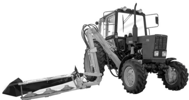
Рисунок 2 – Механизация удаления НДКР в полосе отвода железных дорог
