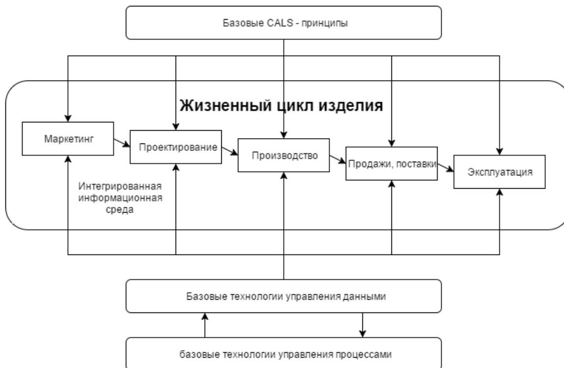
Рис. 1 Схема применения CALS-технологий на предприятии
