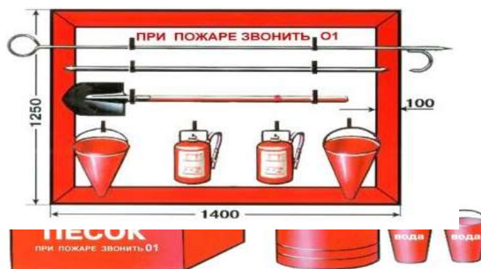
Рисунок 6 - Пожарный щит первичных средств пожаротушения
