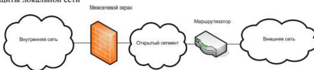
б) подключение межсетевого экрана с двумя сетевыми интерфейсами при выделении открытого сегмента внутренней сети
