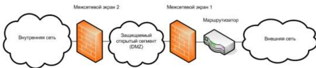
д) подключение двух межсетевых экранов для защиты внутренней сети и ее открытого сегмента
