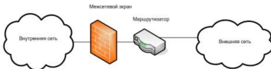
а) подключение межсетевого экрана с двумя сетевыми интерфейсами для «единообразной» защиты локальной сети
