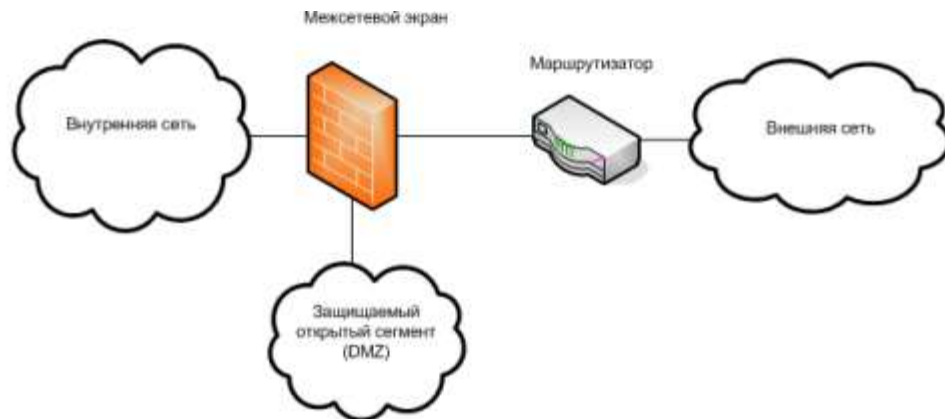
с) подключение межсетевого экрана с тремя сетевыми интерфейсами для защиты внутренней сети и ее открытого сегмента
