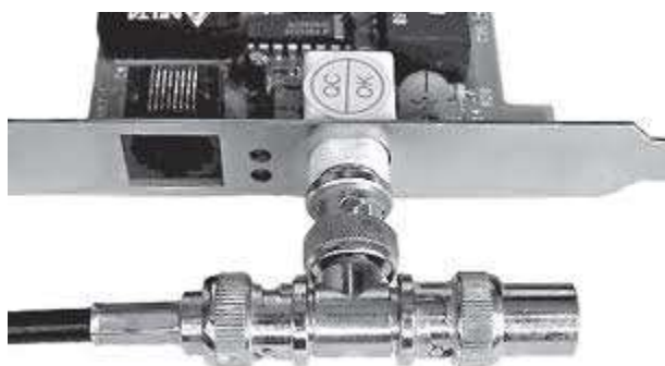
Рис. 14.2. Т-коннектор, присоединенный к сетевой карте
