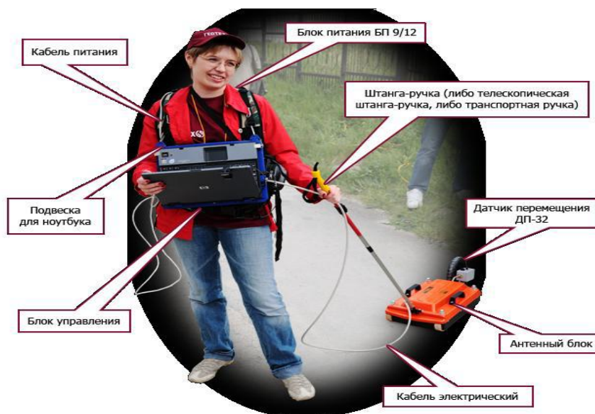
Рисунок 4. Состав георадара ОКО-2(универсальный базовый комплект + АБ400М + ДП-32 + ноутбук).
