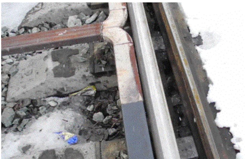
Рисунок 2. Система газообогрева на стрелочном переводе.
