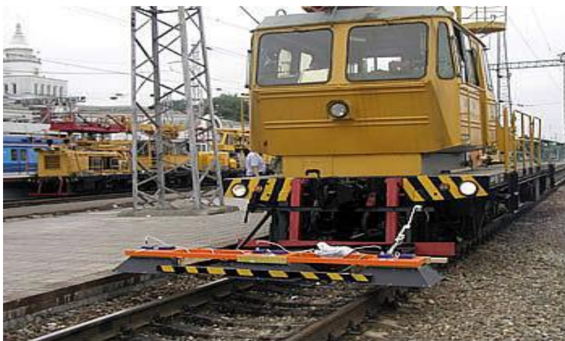
Рисунок 2. Трехканальный георадарный комплекс с рупорными антенными блоками АБ-400Р
