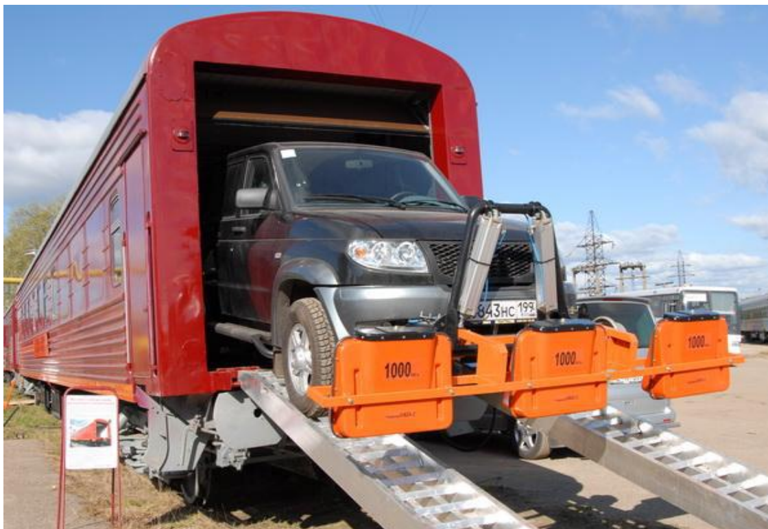
Рисунок 3. Комплекс скоростной георадиолокации земляного полотна «ОКО»
