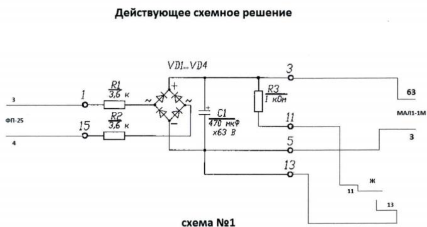
Рис. 1 Типовая схема ПВ и контакта реле Ж
