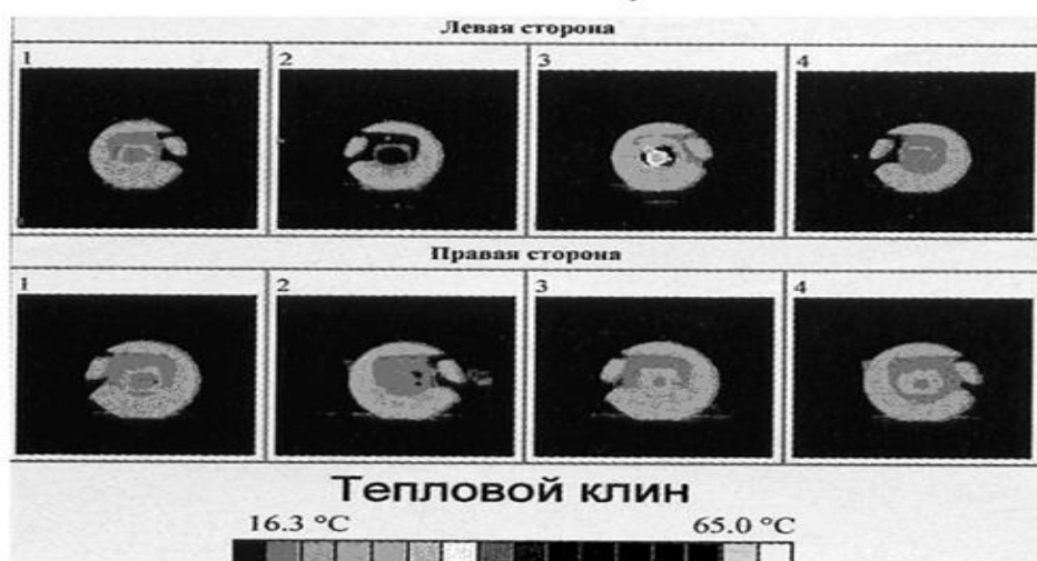
Рис 3. - Тепловой паспорт вагона
